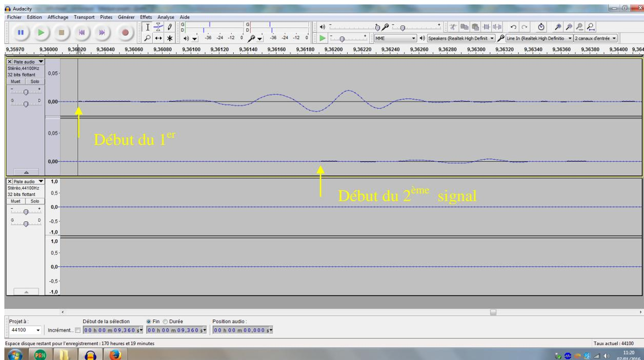
Le début du 1<sup>er</sup> signal est à  $t_1 = 9,36020$  s (5 chiffres derrière la virgule nécessaires).
