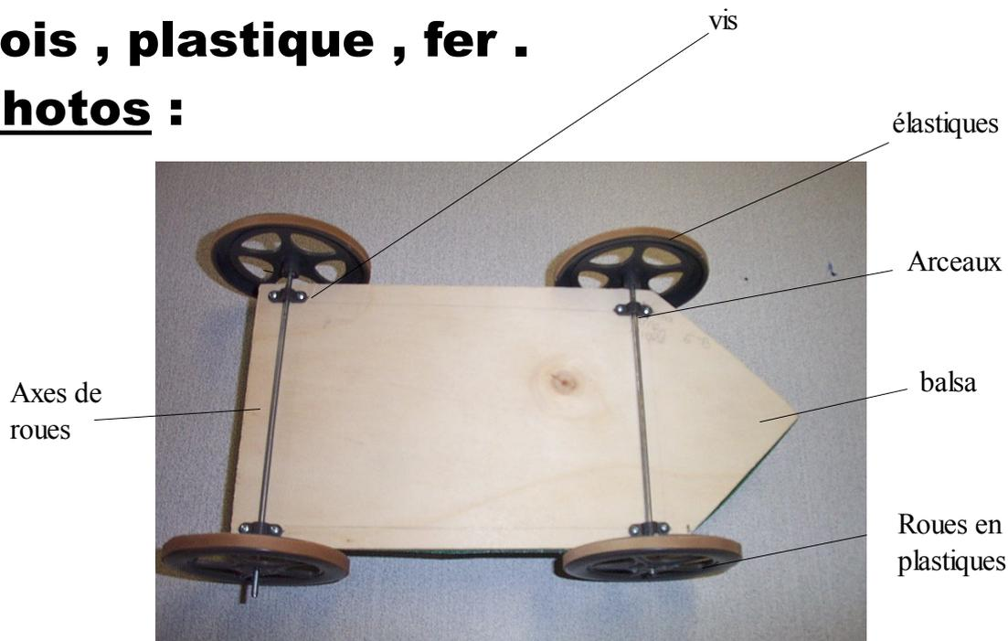
**matériaux : axes de roues , roues , vis , arceaux , balsa .**
